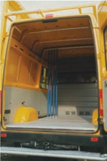
Zur Produktpalette von Klemm zählen auch Innenreiffs, hier eine Variante mit der Türen oder Fensterrahmen senkrecht im Laderaum transportiert werden können Bilder: Klemm
