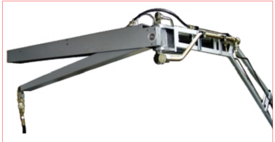
Das schwere Schlauchpaket, durch das der Klebstoff gepumpt wird, kann bei dieser Anwendung verkürzt werden, da ein zweites horizontales Drehgelenk am Schwenkarm zum Einsatz kommt
