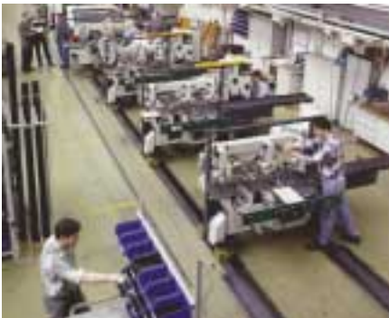
Vor der Auslieferung können bei Weinig Maschinen bereits im Werk in Betrieb genommen werden, um Produktionsunterbrechungen beim Kunden zu verkürzen
