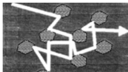
Bild 4: Schematische Darstellung der Lichtstreuung an Partikeln
