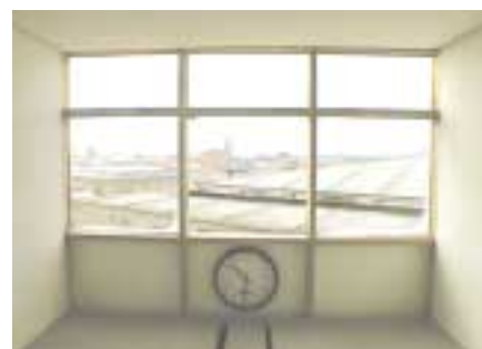
Bild 1: Büroraum mit thermotrop schaltbarer Verglasung im Oberlichtbereich bei eben einsetzender Schaltung in den Bereichen der Verglasung, auf die direktes Sonnenlicht fällt. In dem obersten Streifen befindet sich die Verglasung im klaren, völlig ungetrübten Zustand
