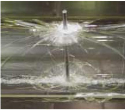
**Bild 2:** Das Verbundglasrohr kann von einem Stahl Nagel (unter Vollast) durchdrungen werden, ohne daß es versagt
