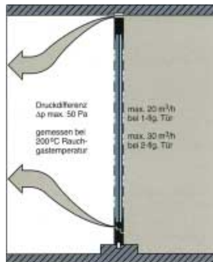
Bild 5: Neben der Prüfung der Rauchdichtigkeit müssen je drei Türen 200 000 mal geöffnet und geschlossen werden – nach dieser Dauerfunktionsprüfung müssen alle Beschlagteile voll funktionstüchtig sein
