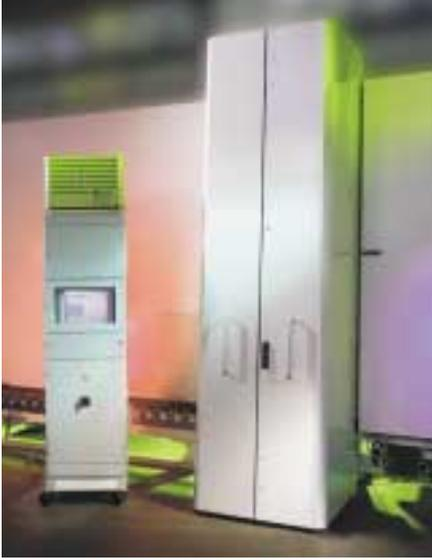
**„Visionmaster“ – für die vollautomatische, optische In-Line-Inspektion von Glastafeln**
