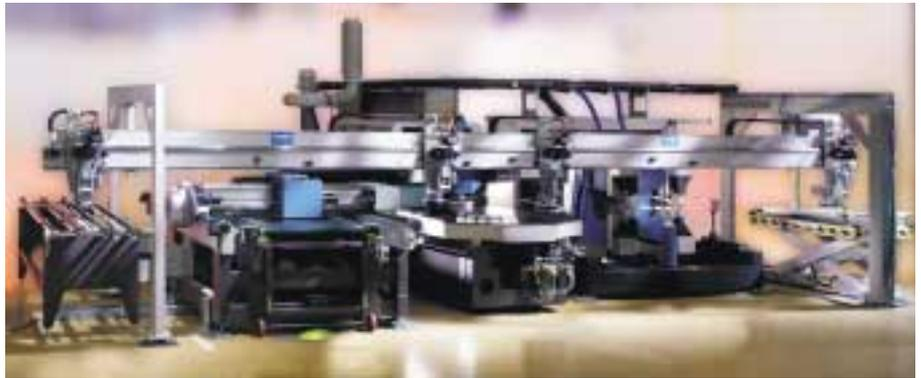
Die neue Fertigungslinie „Champ'compact“ ermöglicht das integrierte Schneiden, Brechen, Schleifen und Bohren hochwertiger Formgläser für die Fahrzeugindustrie
