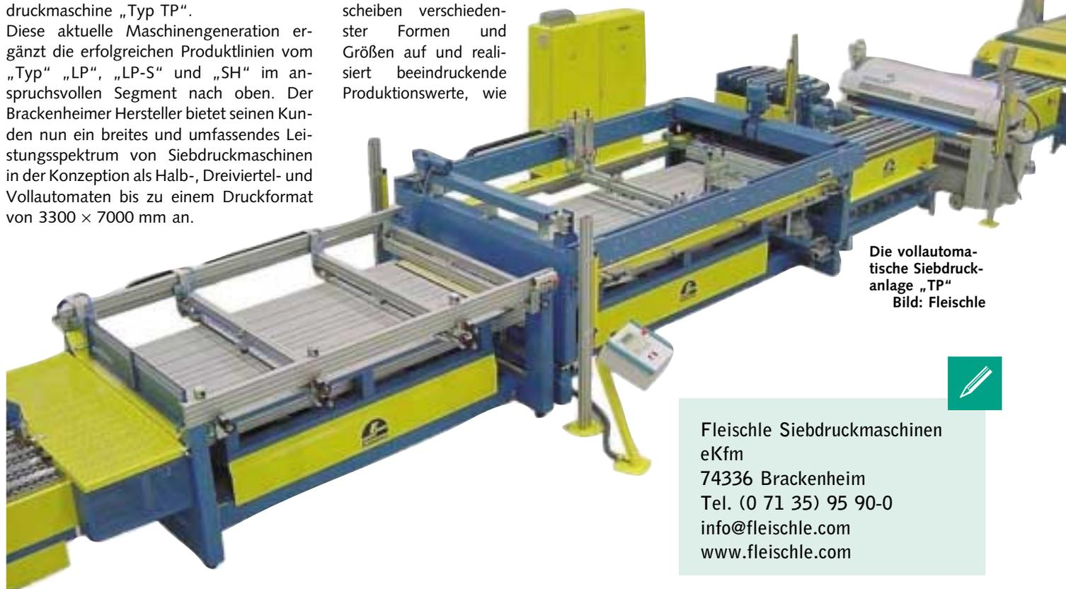
Die vollautomatische Siebdruckanlage „TP“
