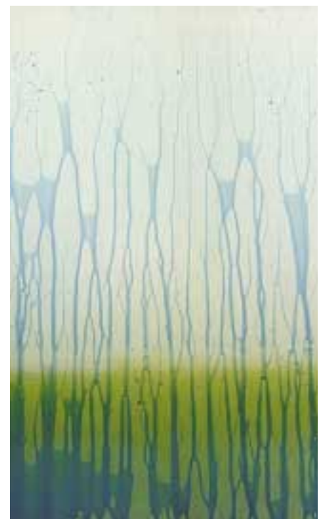
Hochmodulgewebe ohne Spezialbehandlung mit ungleichmäßiger Benetzung
