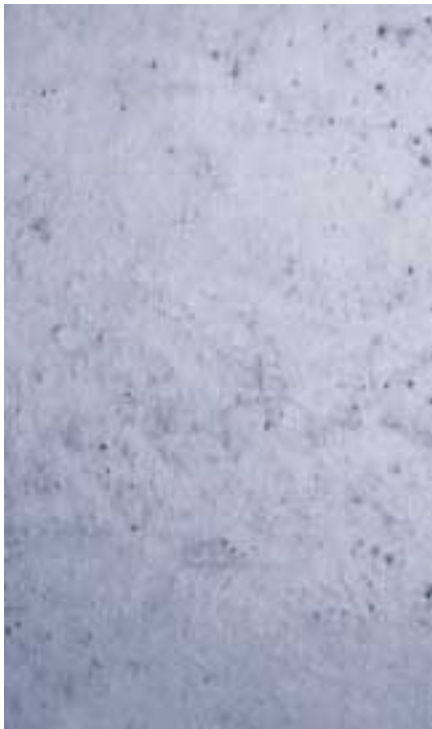
Gleichmäßiger Farbauftrag bei „PET 1500“
