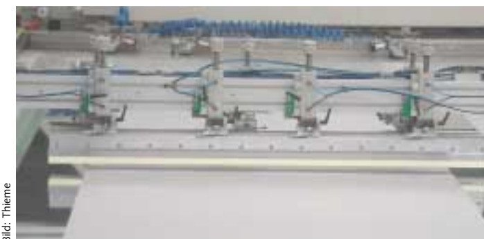
Das patentierte Thieme-Rakelwerk mit gleichmäßigem Druck über die gesamte Rakellänge
