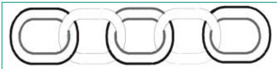
Bild 3: Kettenmodell der Klebung
