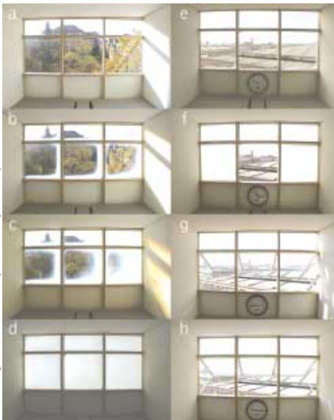
**Bild 3:** a–d: Schaltvorgang einer mit thermotropen Hydrogel-Verbundscheiben ausgestatteten Bürofassade als 1:2,5 – Skalenmodell am Lehrstuhl für Gebäudetechnologie, Prof. Herzog, TU, München. Um den Vorgang zu verdeutlichen wurde die gesamte Fassade thermotrop belegt, was in der Anwendung kaum sinnvoll ist. e–h: Andere Anordnungen: nur teilflächige Belegung klar (e) und geschaltet (f) und als auskragendes Element klar (g) und geschaltet (h)
