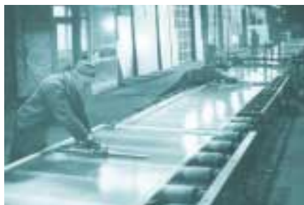
So wurde früher Glas geschnitten – heute funktioniert das vollautomatisch
