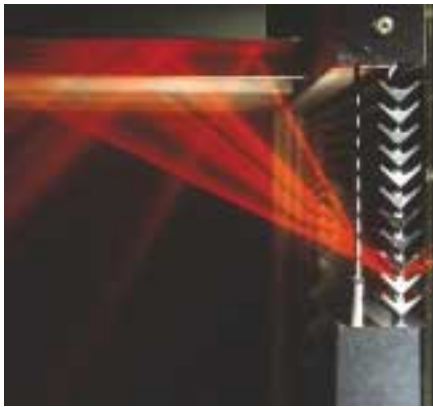
Bild 3: Fischchen-Umlenkensystem – Simulation des Strahlenganges durch Laserlicht
