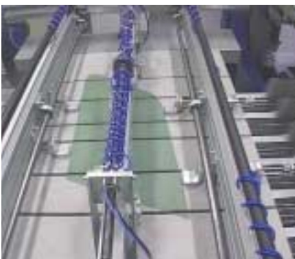
Exakte Positionierung der Glasscheibe auf 1/100 mm
