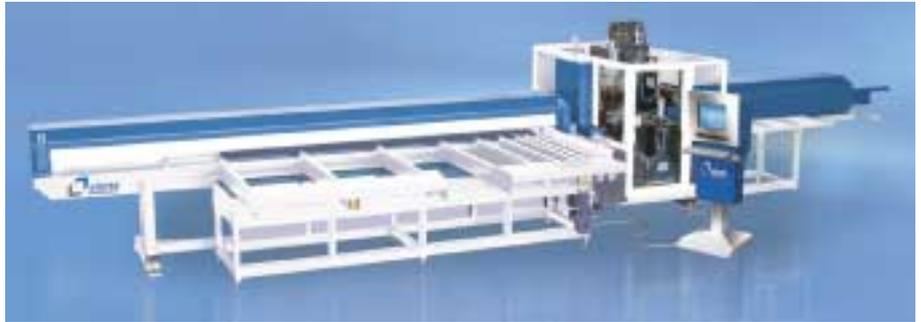
Mit dem „STBAZ-NFZ Compact“ präsentiert Stürtz ein vollautomatisches Bohr- und Fräszentrum, daß alle erforderlichen Arbeitsschritte am fertig zugeschnittenen Profilstab selbständig abarbeitet
