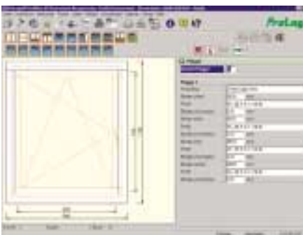
Konstruktion von Holz-Alu-Fenster bei der Wahl der Anschlagart mit Möglichkeit der Flügelprofiländerung
