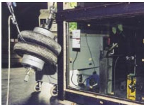
**Versuchsaufbau für einen Pendelschlag mit dem Zwillingsreifen: Der Einbau der Scheibe in eine starre Rahmenkonstruktion stellt eine Höchstbelastung dar**
