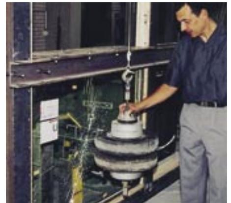
**Nach erfolgreichem Test wird das Ergebnis des Pendelschlages inspiziert: Viele Brandschutzglastypen von Pilkington „Pyrostop“ und „Pyrodur“ blieben bei Fallhöhen von 900 mm unbeschädigt**
