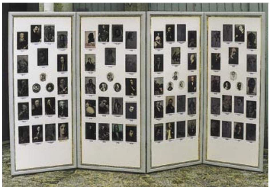
Bild 1: Stellschirm aus vier Rahmen, verbunden mit Paravent-Scharnieren. Jeder Rahmen umschließt ein Passepartout mit 37 Fensterausschnitten. Ausgeführt sind die Schnitte mit einem computergesteuerten „Gunnar“-Schneidautomaten.
