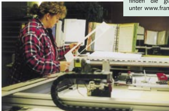
Bild 4: Dörthe Schröder, geschulte Mitarbeiterin der Passepartout-Werkstatt Reinhard Dreger, an einem computergesteuerten Passepartout-Schneidautomaten von „Gunnar“
