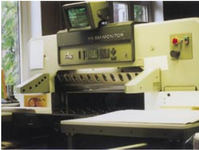
Bild 6: Die diesem Schneidautomaten werden in der Passepartout-Werkstatt Dreger Passepartouts auf Außenmaß geschnitten
