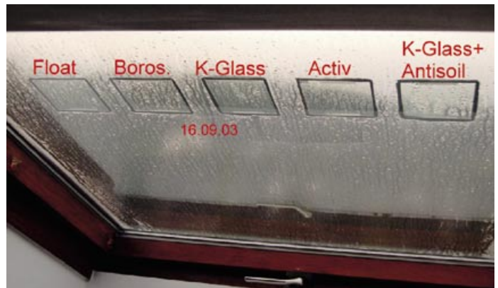
Bild 2: Taubeschlagsituation während der zweiten Versuchsserie bei hoher Außenluftfeuchtigkeit
