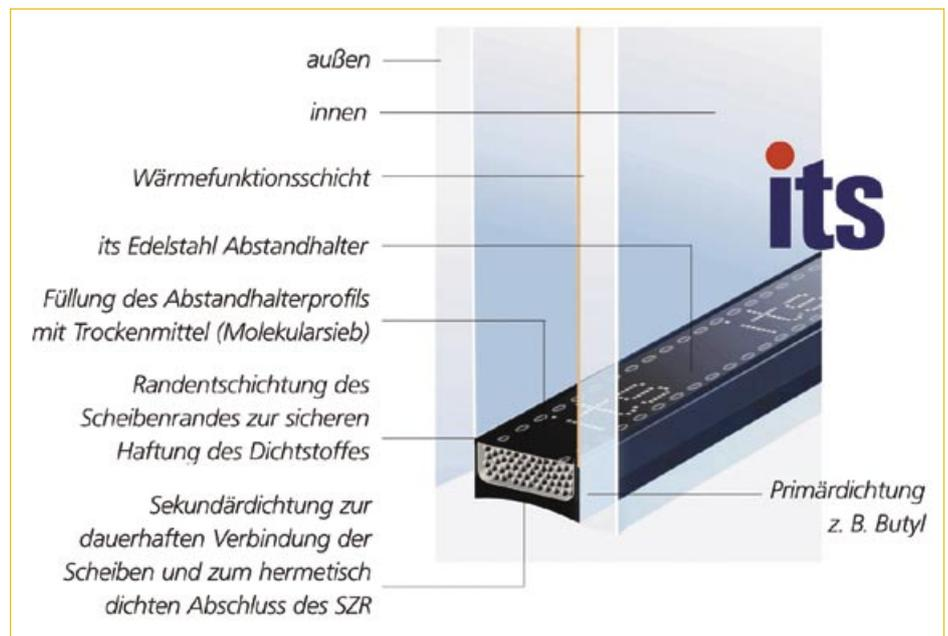
**Verbesserte Wärmedämmung:** Für das neue Abstandhalterprofil „its“ kommt Edelstahl statt herkömmlicher Aluminium-Abstandhalter zum Einsatz. Damit sinkt der längenbezogene Wärmedurchgangs-Koeffizient um ca. 25 %
