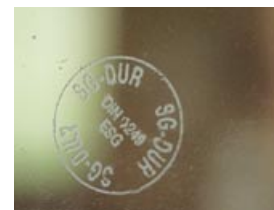
Bild 7: Dieser Stempel enthält normgerechte Bezeichnung und einen Firmen-Hinweis mit der Endung „Dur“
