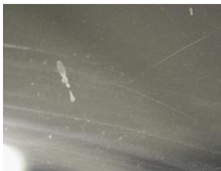
Bild 2: Leichtere Kratzer in einer ESG-Scheibe
