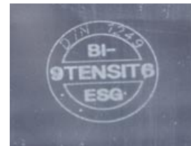
Bild 6: Eine normgemäße Kennzeichnung zeigt dieser Stempel
