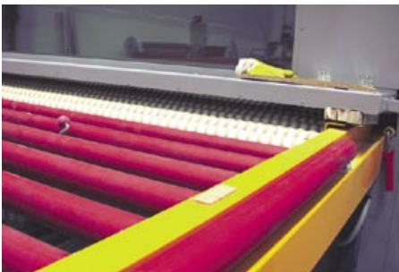
Bild 4: Vor dem ESG-Ofen werden die fertig bearbeiteten Scheiben auf Rollenbahnen aufgelegt
