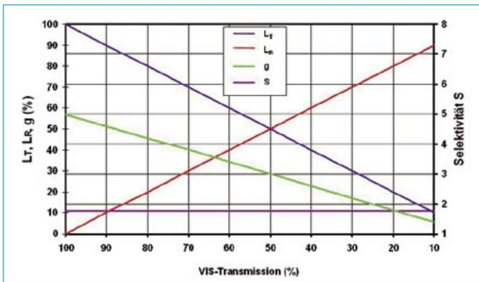
Bild 3: Verlauf  $L_T$ ,  $L_R$ ,  $g$  und  $S$  bei abnehmender Transmission im sichtbaren Spektralbereich
