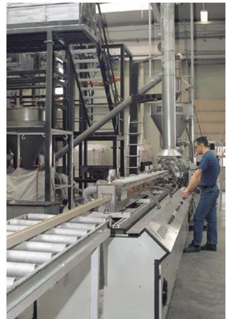
Der „Fasalex“-Strang wird nach dem Extrudieren abgekühlt und dann auf die vorgesehene Länge zugeschnitten
