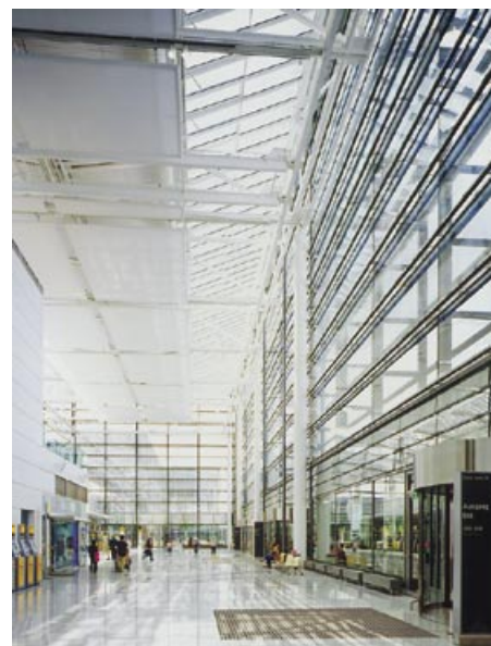
Für die Lichtsegel in der Halle existieren vier definierte Stellungen – gut zu sehen sind die Nachstromöffnungen
