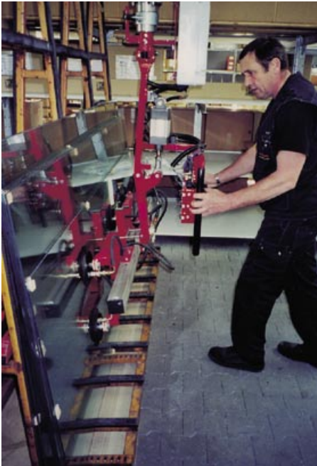
Bild 3: Ergonomische Entnahme von Glasplatten aus einem Spezialständer im Winkel von 10°
