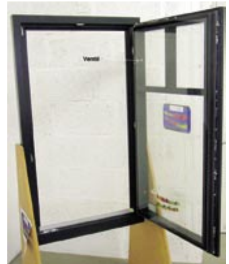
Bild 6: Gebauter Prototyp mit getrennten Profilen der Firma Traser, Darmstadt. Hier kam das leichte „Lightglas“ zum Einsatz
