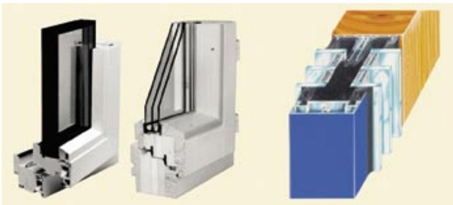
Bild 2: Hier sind verschiedene hochdämmende Fenster-Profile gezeigt: PVC-Profil mit PUR-geschäumten Kammern, Holzprofil mit innenliegender Dämmung und Holz/Alu-Pfosten-Riegel-Konstruktion mit Dämmvorsatz (von links)
