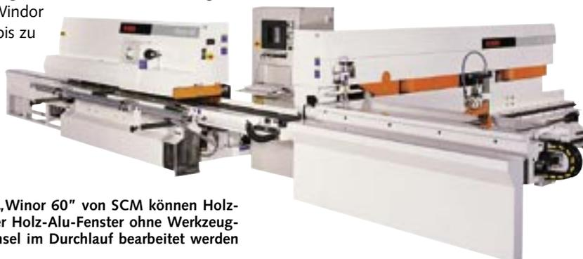
Mit der „Winor 60“ von SCM können Holzfenster oder Holz-Alu-Fenster ohne Werkzeugwechsel im Durchlauf bearbeitet werden
