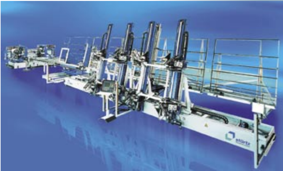
Die Double-Line von Stürtz mit zwei vertikalen Schweißmaschinen und horizontalem Zweikopf-CNC-Verputzer erlaubt eine Fertigungstiefe von bis zu 240 Fenstereinheiten in acht Stunden
