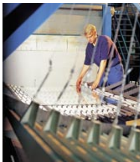
Beim Biegen von Glas kommt es neben dem entsprechenden Maschinenpark vor allem auf das Know-how der Mitarbeiter an, da hierbei viel Fingerspitzengefühl notwendig ist
