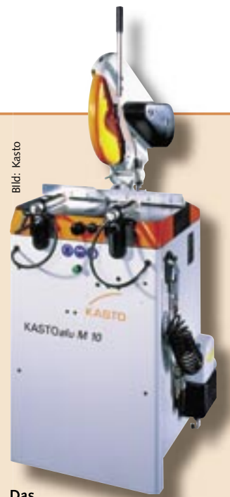
Das Basismodell „Kastoalu M 10“ zum manuellen Gerad- und Gehrungssägen von Alu- und Kunststoff-Profilen
