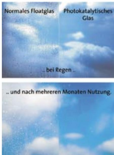
**Bild 3:** Wirkung von photokatalytischem Glas (hier „Bioclean“ von SGG) in Vergleich zu normalem Floatglas
