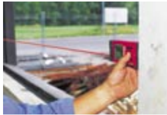
Der Hilti-Distanzmesser „PD 30“ ist bis 200 m (+/- 1,5mm) messgenau und passt zudem in die Hemdtasche
