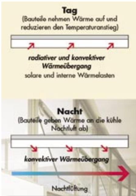
**Funktionsweise der Nachtlüftung:** Am Tag nimmt die Decke Wärme auf, in der Nacht strömt kühle Außenluft durch den Raum (Klappen) und kühlt die Decke
