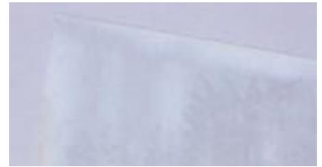
**Bild 3:** Bei unsymmetrischer Wärmeübertragung können solche Verbrennungen in der Low-E Beschichtung durch Überhitzen auftreten
