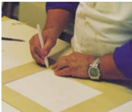
Passepartout-Maske, überzogen mit Honanseide. Mit dem Falzbein wird die Seide der besseren Haftung wegen auf den Kartonuntergrund gedrückt, besonders sorgfältig auf den Oberflächen der Schrägschnitt-Fasen und in den Ecken
