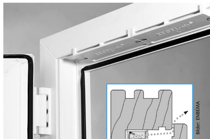
Der „Regel-air“ Fensterfalzlüfter wird verdeckt liegend im Fensterfalz eingebaut und ist somit bei geschlossenem Fenster nicht sichtbar
