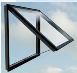
Das „Wing 50 K“-Klappfenster öffnet nach außen und verfügt über eine Verglasungstechnik, die die optischen Effekte einer SG-Verglasung mit den konstruktiven Vorteilen einer Rahmenkonstruktion mit Standard-Isolierglas verbindet. Ermöglicht wird dies durch ein 50 mm schmales Flügelprofil, unsichtbar verschraubt auf der Außenseite, das einstückig und fugenfrei ist und durch einen Versatz von nur 4 mm zur Glasoberfläche eine SG-Optik wiedergibt.
