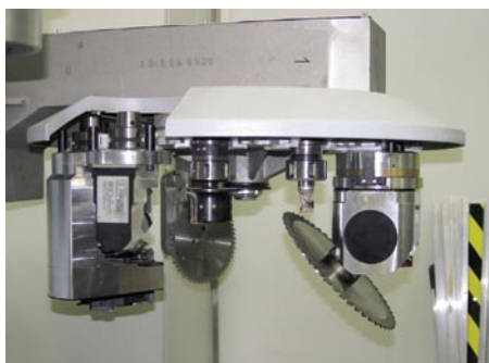
Bild 2: „Flex5“-Aggregat im Standard Tellerwechsler für Werkzeuge und Aggregate
