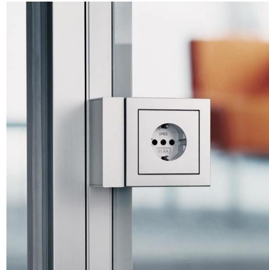
Bei dem Gira-Installationssystem „ITS 30“ werden spezielle Installationsgehäuse auf einer schmalen Basisschiene angebracht, die dann die Elektroanwendungen – Steckdosen, Schalter und Jalousiesteuertaster – aufnehmen. Einbinden lässt sich zudem der „SmartSensor“ von Gira, eine Kontroll- und Bedieneinheit für sämtliche Instabus-Funktionen im Raum
