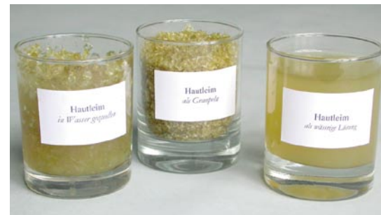
Hautleim ist der Leim der Vergolder. Die Granuln lässt man in Wasser quellen. Die Quellmasse, im Wasserbad erwärmt, ergibt den gebrauchsfertigen Leim, der nach Bedarf verdünnt werden kann
