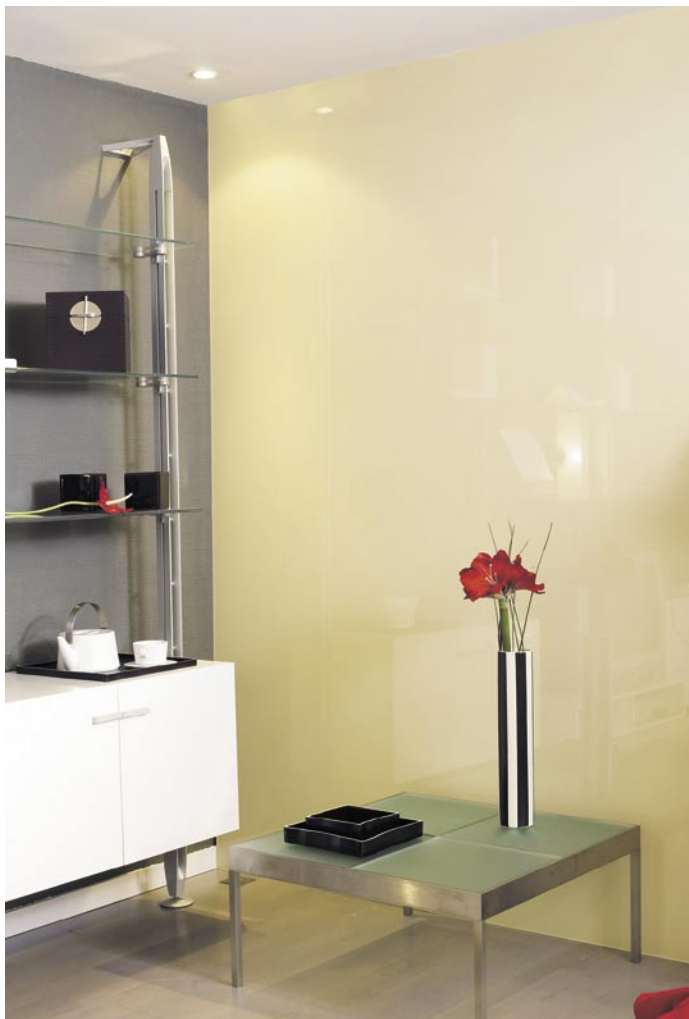
Das neue Designglas „SGG Planilaque Evolution“ ist ein undurchsichtiges, lackiertes Glas (hier im Farbton Elfenbein), das durch Aufbringen eines deckenden, hochwiderstandsfähigen Lacks auf einer der Glasseiten hergestellt wird
