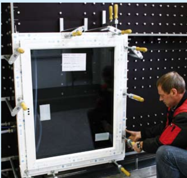
Auf Prüfständen werden in jedem Betrieb die Konstruktion und die Funktion von Fenstern getestet.
