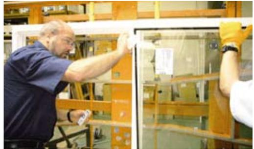
Der nächste Schritt ist die Reinigung des Isolierglas-Randverbunds
