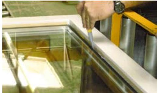
Einbringen des Klebstoffs OTTOCOLL® S81 in den Falzgrund. Für die Verarbeitung des Spezial-Klebstoffs wird die Druckluft-Pistole P TS 460 XH benötigt
